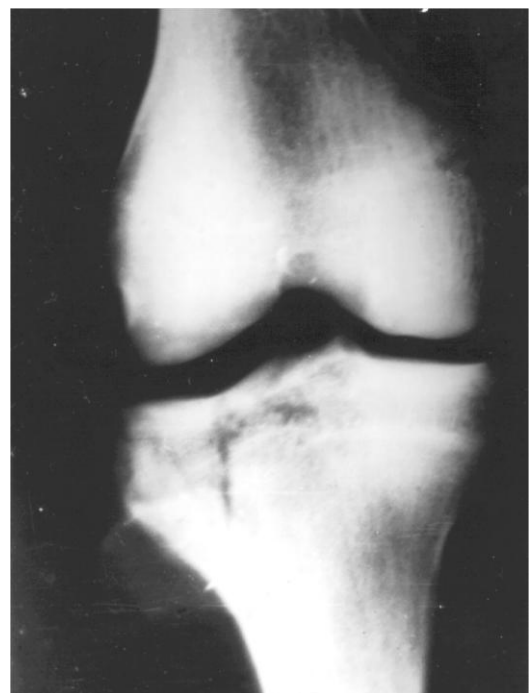
Рис. 3.9. Рентгенограмма анатомического препарата с переломом мыщелка большеберцовой кости после нагрузки на установке ГРМ-500
