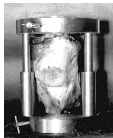
Рис. 3.7. Анатомический препарат коленного сустава в зажиме установки ГРМ-500
