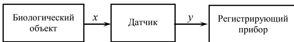
Рис. 1. Принципиальная структурная схема измерения неэлектрической величины электрическим методом
